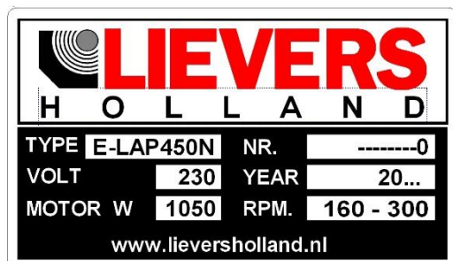
Abb. 1: Muster Typenaufdruck E-LAP450N Der Typenaufdruck befindet sich auf dem Motor.
