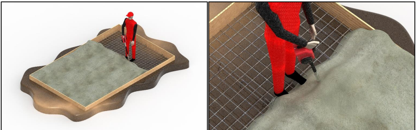
Figuur 6: Werkwijze tijdens het beton verdichten.
